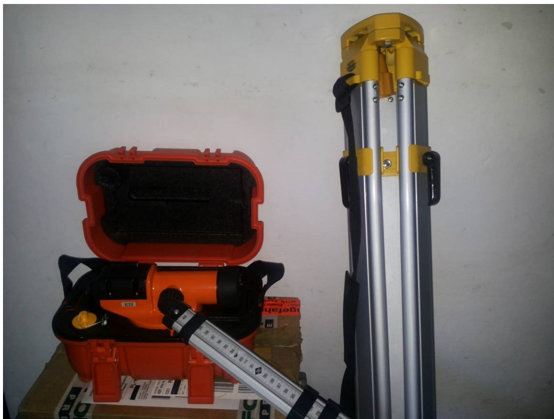
fot.1. Widok zestawu do określania krzywizny stropów.
